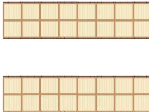
*МАТЫ УКЛАДЫВАЮТСЯ ПЕРПЕНДИКУЛЯРНО ПОД НАПРАВЛЯЮЩИЕ БАЛКИ ОСНОВАНИЯ БУРОВОЙ УСТАНОВКИ, ОБРАЗУЯ ДВЕ ПАРАЛЛЕЛЬНЫЕ ЛИНИИ.*
