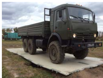
// Перекрытия нешироких канав, траншей, воронок
